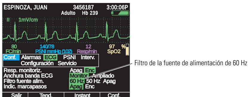
Figura 64. Activación del filtro de la fuente de alimentación de 60 Hz en el menú de configuración del ECG
