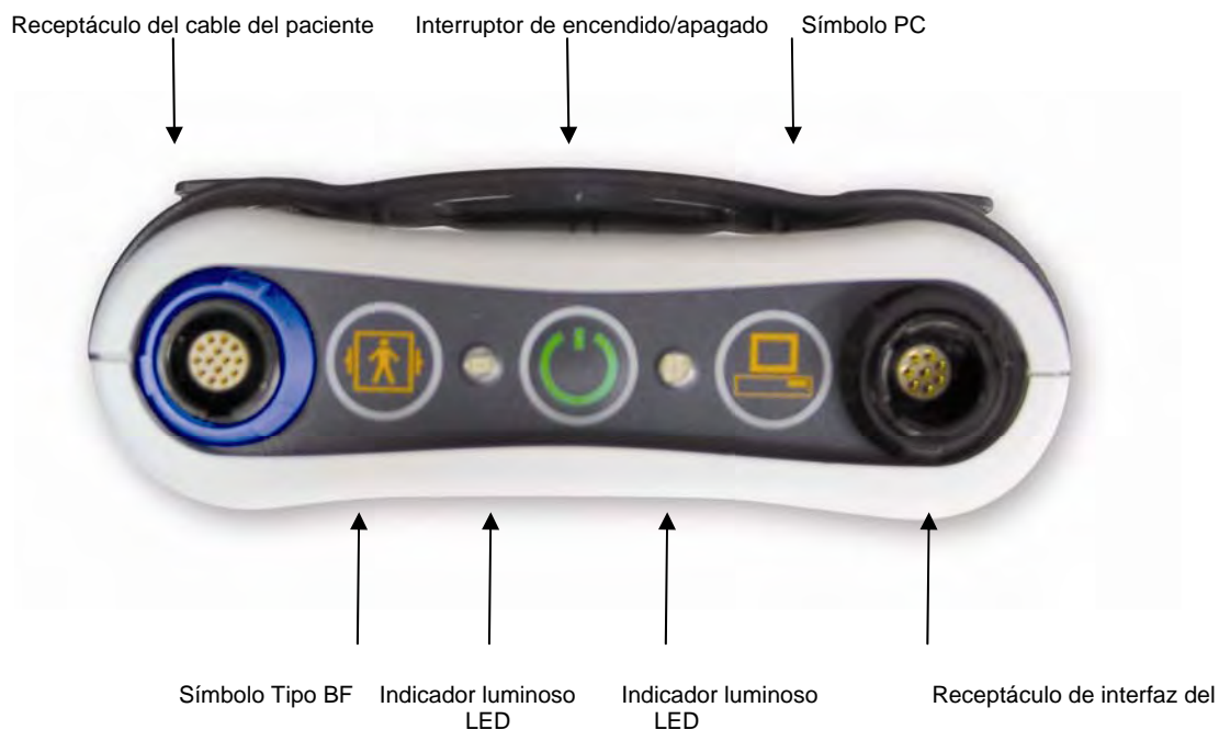
Figura 1 Vista frontal del electrocardiógrafo CardioPerfect Pro
