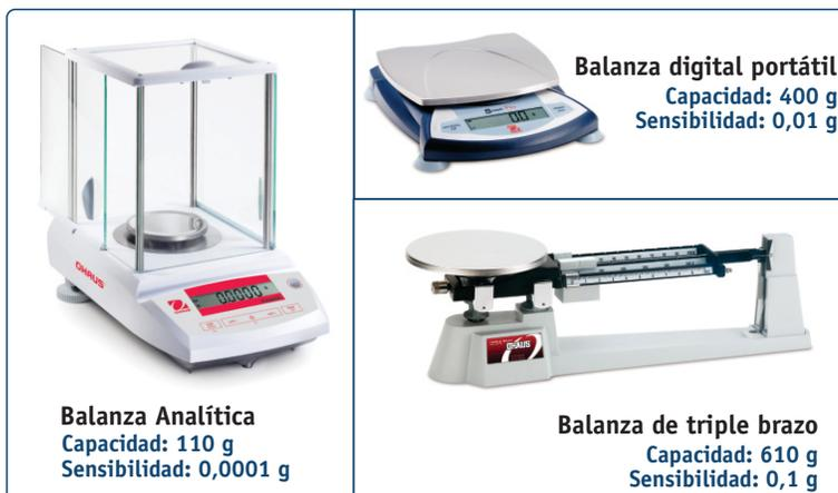
**Figura 1:** Balanzas de uso común en el laboratorio.
