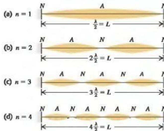
Figura 6.1: Modos de Oscilación en una Cuerda
