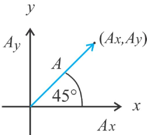
Figura 3.1: La flecha azul representa un vector en el plano. Las coordenadas del punto final de vector (donde termina la flecha), nos sirven para darle un nombre o etiqueta única a cada vector. A partir de ese nombre es posible conocer toda la información relevante sobre el vector: su magnitud y dirección.
