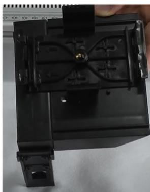
Figura 3.3: Soporte para el sensor de luz y color.
