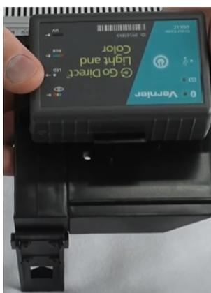
Figura 3.4: Configuración final del sensor de luz y color en el soporte.
