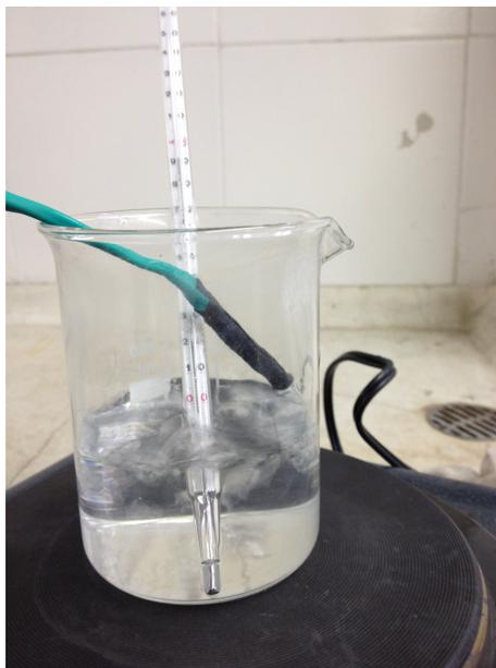
Figura 5.3: Montaje experimental para la ley de enfriamiento. Sensor LM35
