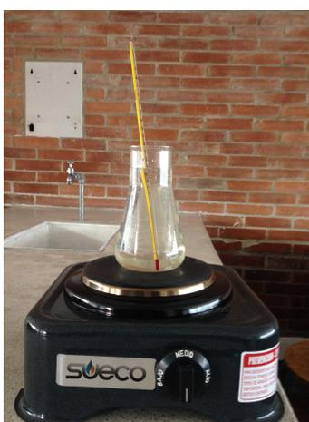
Figura 5.1: Montaje experimental para la ley de enfriamiento. Termómetro de Mercurio.
