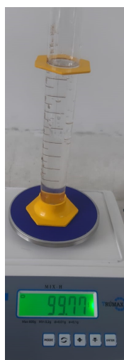
Figura 7.4: Medida de la masa de 100 ml de agua.
