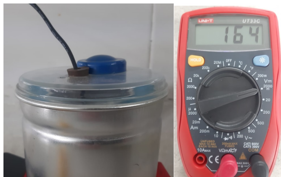
Figura 7.3: Medición Temperatura sistema Agua Caliente - Agua Fría - Calorímetro
