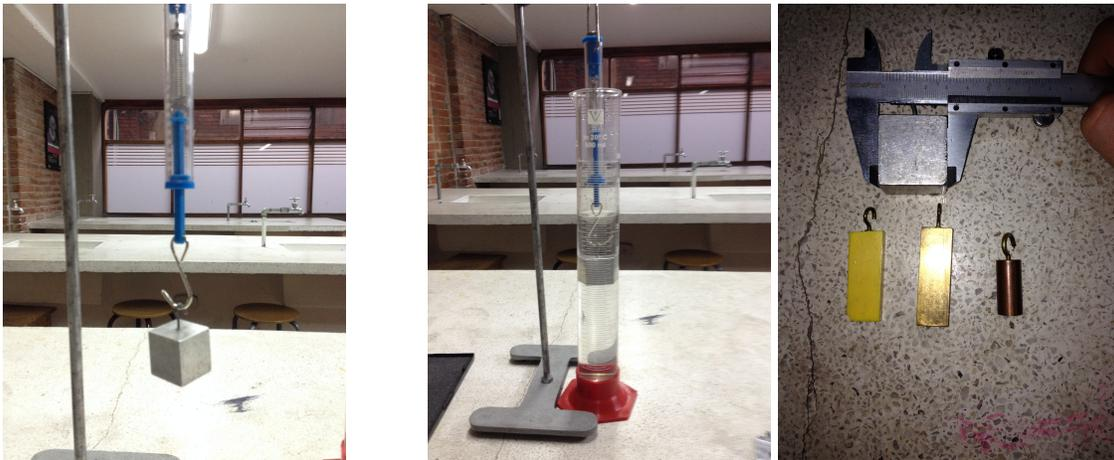
Figure 2.2: Medición del peso del objeto. *Izquierda* en el aire. *centro* en el seno del fluido. *derecha* Medición de las dimensiones de los objetos para la determinación de su volumen.
