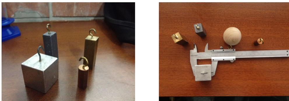
Figure 1.1: Medición de longitudes de sólidos regulares. *Izquierda* Sólidos suministrados. *derecha* Mediciones con calibrador pie de rey.
