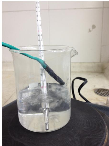
Figure 5.3: Montaje experimental para la ley de enfriamiento. Sensor LM35
