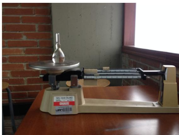
Figure 1.3: Determinación de la densidad de un fluido con picnómetro.
