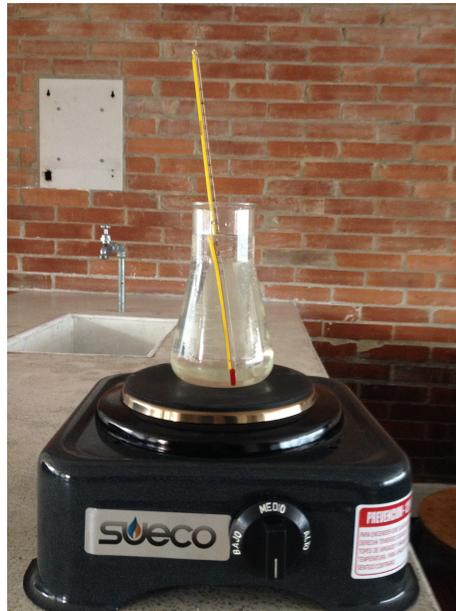
Figure 5.1: Montaje experimental para la ley de enfriamiento. Termómetro de Mercurio.
