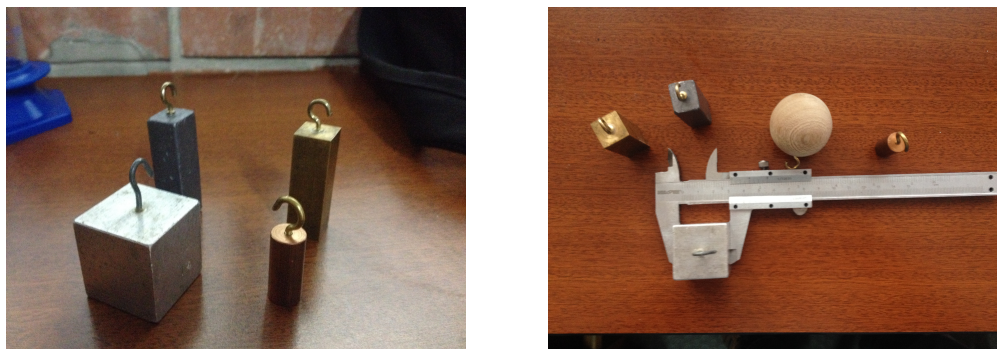
Figura 1.1: Medición de longitudes de solidos regulares. Izquierda Solidos suministrados. Derecha Mediciones con calibrador pie de rey.
