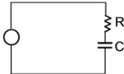
Figura 1. Esquema de un Circuito Resistencia y Condensador
