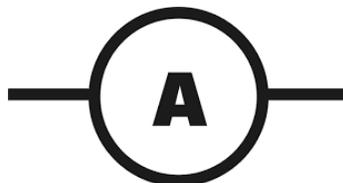
Figura 3. Representación de un Amperímetro
