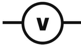
Figura 1. Representación de un Voltímetro
