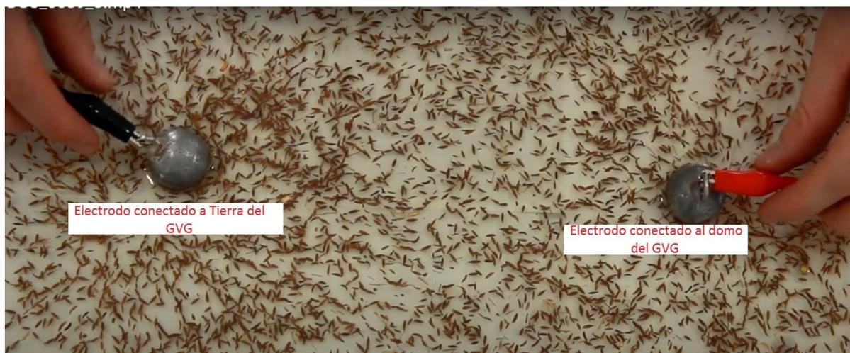
Figura 3.2: Montaje experimental para la observación de líneas de campo eléctrico.
