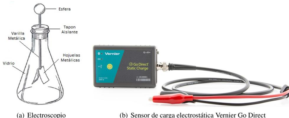
Figura 2.1: Dispositivos experimentales para detectar y cuantificar carga electrostática.
