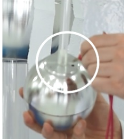
(b) Conexión de esfera de descarga mediante conductor eléctrico.
