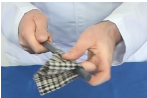
Figura 1.7: Frote con fuerza la varilla de PVC con el trapo de lana, realizando una buena presión con sus dedos mientras frota los dos elementos.
