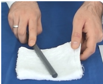
Figura 1.6: Descarga electrostática de elementos utilizando un trapo de algodón húmedo.
