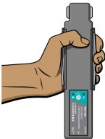
Figura 1.4: Ubicación del sensor para la medición de la fuerza de agarre en la mano.
